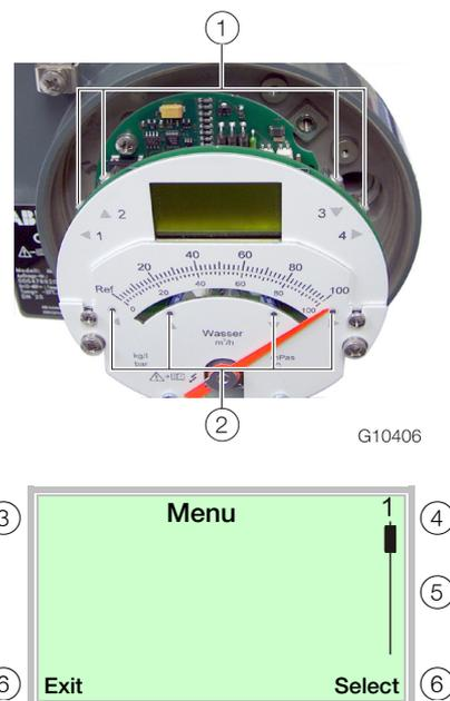
**Fig. 28: LCD display**
